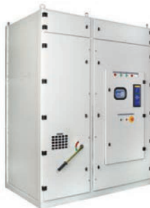
Soft-Start 6kV 250A z szafą przyłączeniową, odłącznikiem, uziemieniem i bezpiecznikami.
